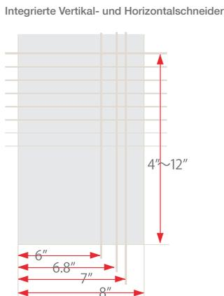
Die integrierten Längsschneider lassen sich in vier Positionen einstellen.
